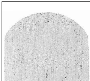
Billede 3: Tværsnit på en bøjeprøve efter bukning på 180°, uden mellem-læg, parallelt i forhold til valse-retningen
